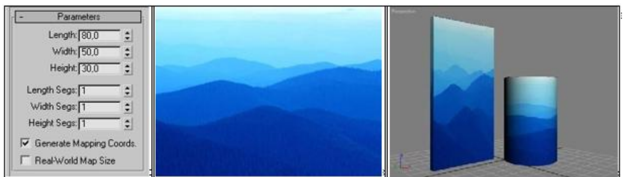
Рисунок 104 - Текстура "подстраивается" под геометрию объектов, что приводит к ее искажениям
