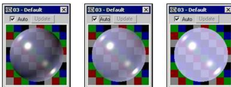
Рисунок 102 - Самосвечение 0, 50, 100. Материал 2-Sided. Параметр
