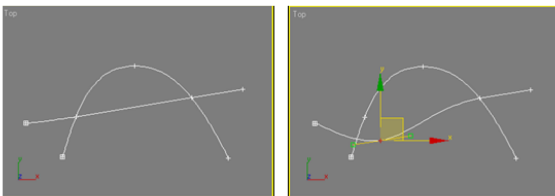
Рисунок 59 - В месте пересечения были созданы две вершины
