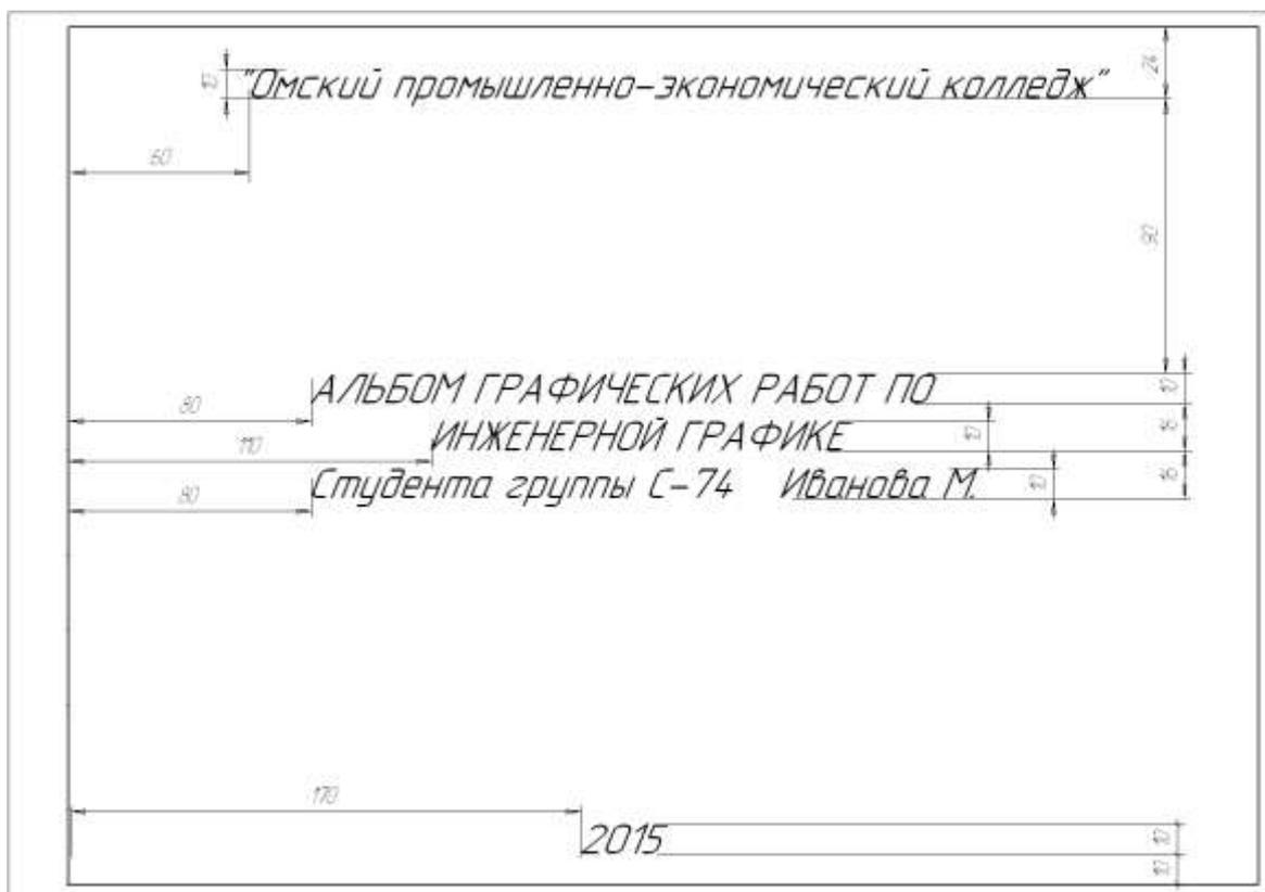
Рисунок 5 – Упрощенная вспомогательная сетка для написания чертежного шрифта
