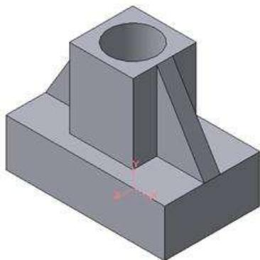
Рисунок 59 - Деталь с построенными ребрами жесткости
