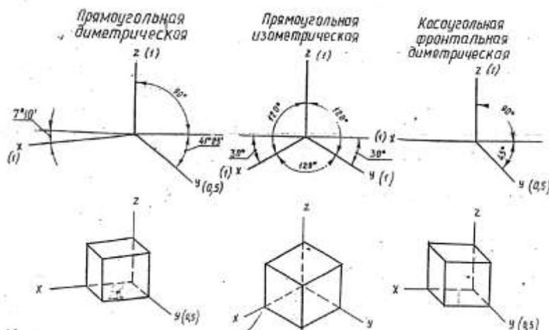
Рисунок 20 - Виды аксонOMETрических проекций
