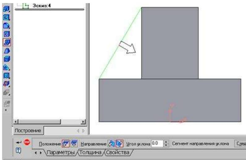
Рисунок 58 - Построение ребра жесткости
