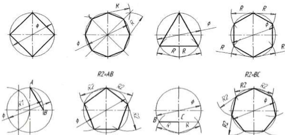
Рисунок 8 - Деление окружности на равные части:
