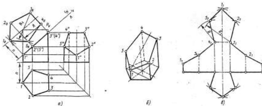
Рисунок 24 - Сечение призмы плоскостью
