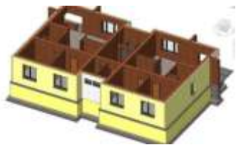
Рис. 7. Модель со скрытым внешним слоем кирпичной кладки
