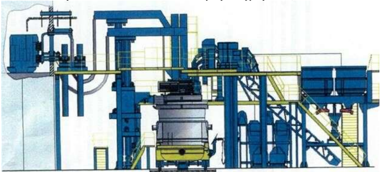
Рисунок 2 - Расположение оборудования агрегата ковш-печь вдоль пролета цеха
