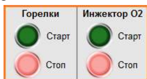
Рисунок 3. Панель управления стеновых газокислородных горелок и кислородных инжекторов
