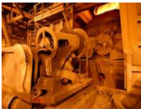
Рис. 1 Машина ТМЛ для сверления футеровки сталевыпускного отверстия
