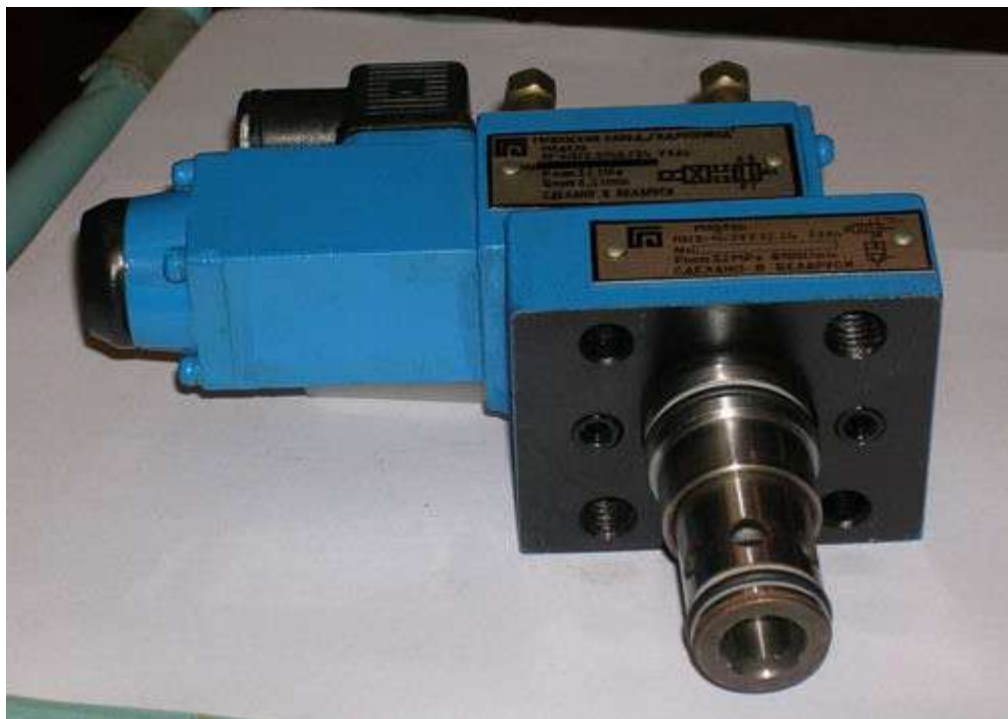
Рисунок 14.3 – Гидроуправляемый встраиваемый клапан МКТВ
