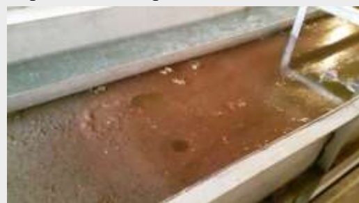
Ржавчина и отложения в результате травления
