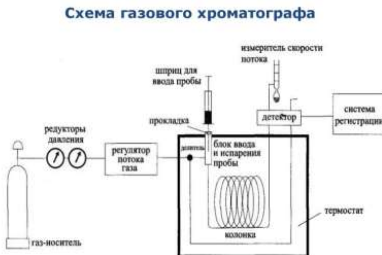
Рис. 2 - Принципиальная схема газового хроматографа: 1 – баллон с газом–носителем; 2 – регулятор расхода; 3 – место ввода пробы (кран–дозатор, испаритель); 4 – термостаты; 5 – колонка; 6 – детектор; 7 – регистратор.
