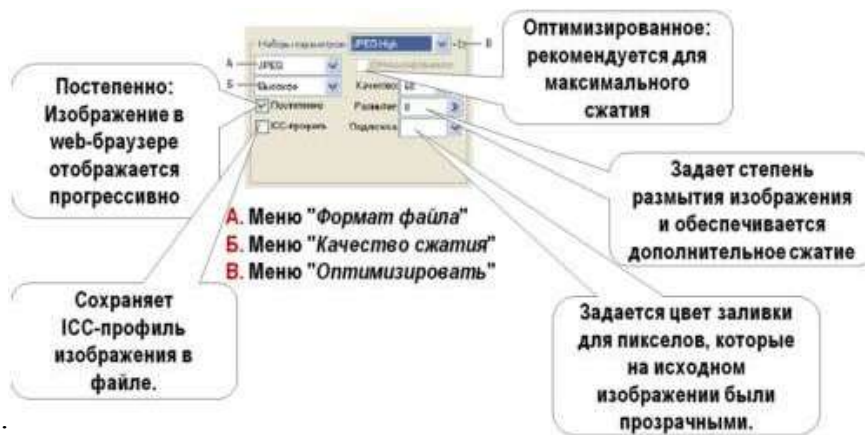
Рис. 1.5. Параметры оптимизации JPEG
