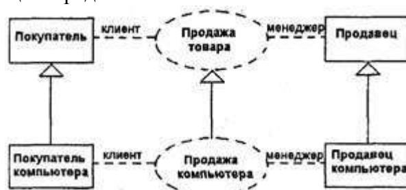
Рис. 2. Графическое изображение отношения обобщения между отдельными кооперациями уровня спецификации
