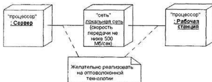
Рис. 3. Фрагмент диаграммы развертывания с соединениями между узлами
