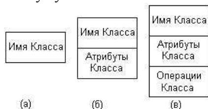
Рис.1. Графическое изображение класса на диаграмме классов
