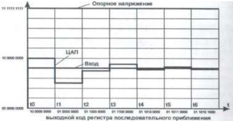
Рис. 2. Принцип работы АЦП последовательного приближения
