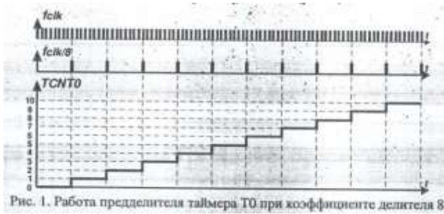
Рис. 1. Работа предделителя таймера T0 при коэффициенте делителя 8
