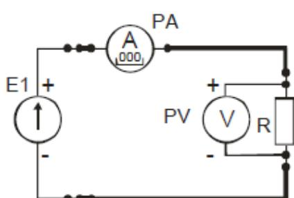
3 Измерить величину сопротивления, заданного преподавателем, методом амперметра и вольтметра. Для
