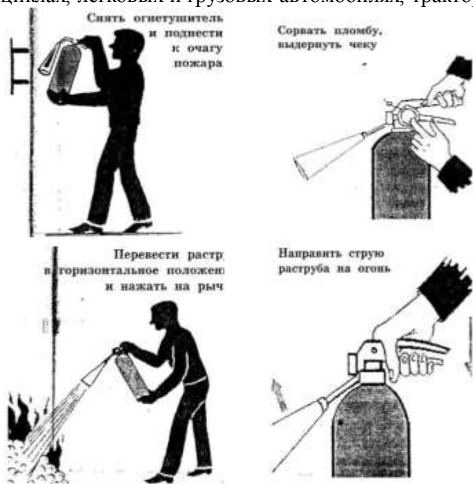
Рис. 3. Приведение в действие ручного углекислого огнетушителя.
