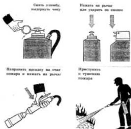
Рис.1. Приведение в действие воздушно-пенного огнетушителя.
