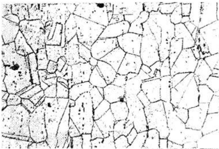
Рис. 11. 11. Структура аустенитной нержавеющей стали 12X18H10T
