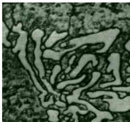
Рис.2 Микроструктура стали после отжига
