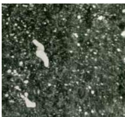
Рис.2 Микроструктура стали после закалки и многократного отпуска
