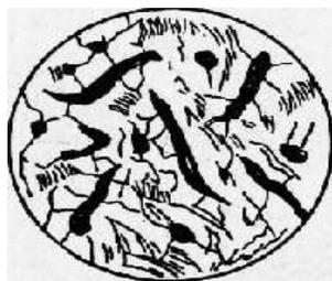
Рис. 8 Структура заэвтектического чугуна
