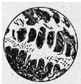
Рис. 7 Структура доэвтектического чугуна
