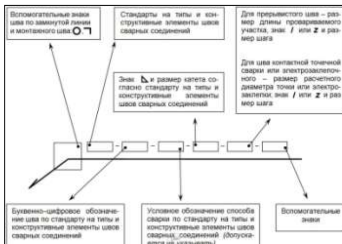
Рис.42,б Условные обозначения швов сварных соединений
