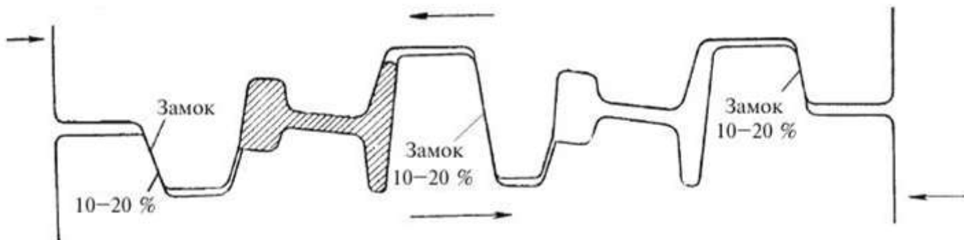
Рисунок 20 - Расположение наклонных рельсовых калибров на валках
