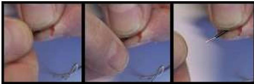
3. Залудить концы проводов. Во время лужения разогретое жало паяльника необходимо подвести к проводу одновременно с припоем. Провод необходимо хорошо разогреть, чтобы припой равномерно распределился по поверхности жгута. Легкое потирание жалом помогает распределению припоя по всей длине лужения.
