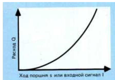
Рисунок 1 – Гистерезис и прогрессивная расходная характеристика
