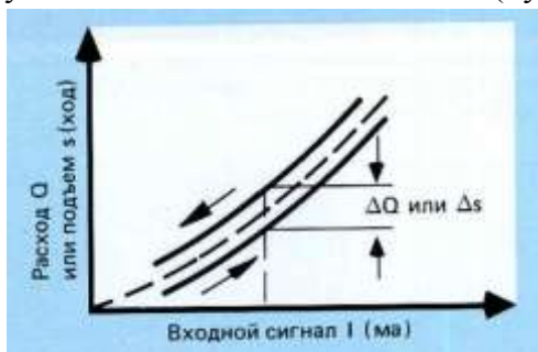
Рисунок 1 – Гистерезис и прогрессивная расходная характеристика
