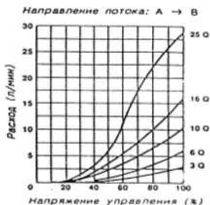
Графики зависимости расхода жидкости через пропорциональный регулятор потока от величины напряжения управления при использовании различных измерительных диафрагм
