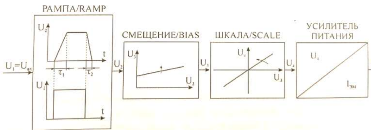
Рисунок 3 – Структура и работа усилителя сигнала
