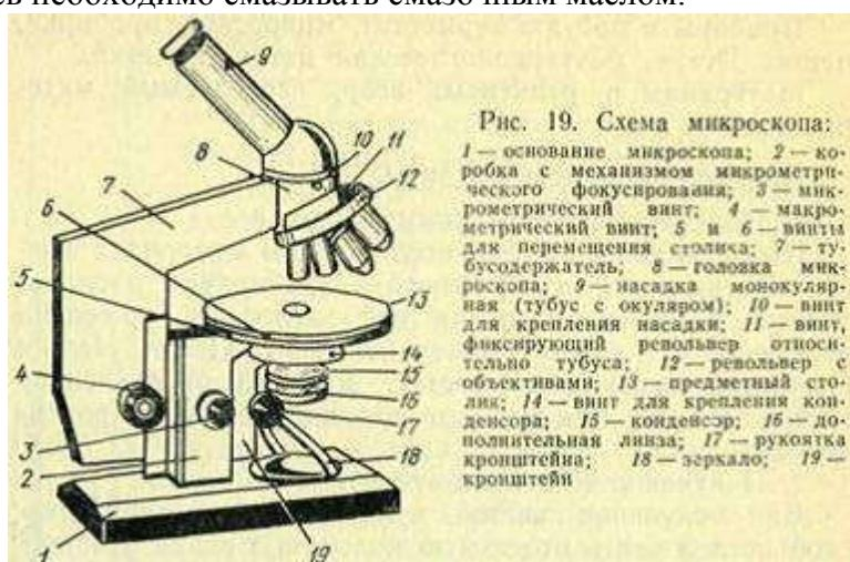
Рис. 19. Схема микроскопа:
