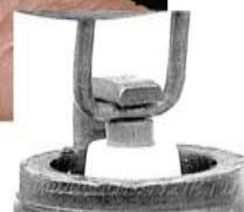
Рис. 56.1. Проверка зазора между электродами свечи с помощью круглого проволочного щупа
