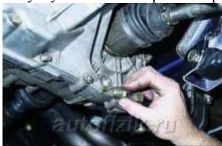
Рис. 2. проверка уровня масла в коробке передач
