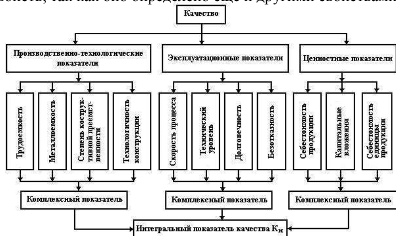
Рис. 5 Структура качества машин.
