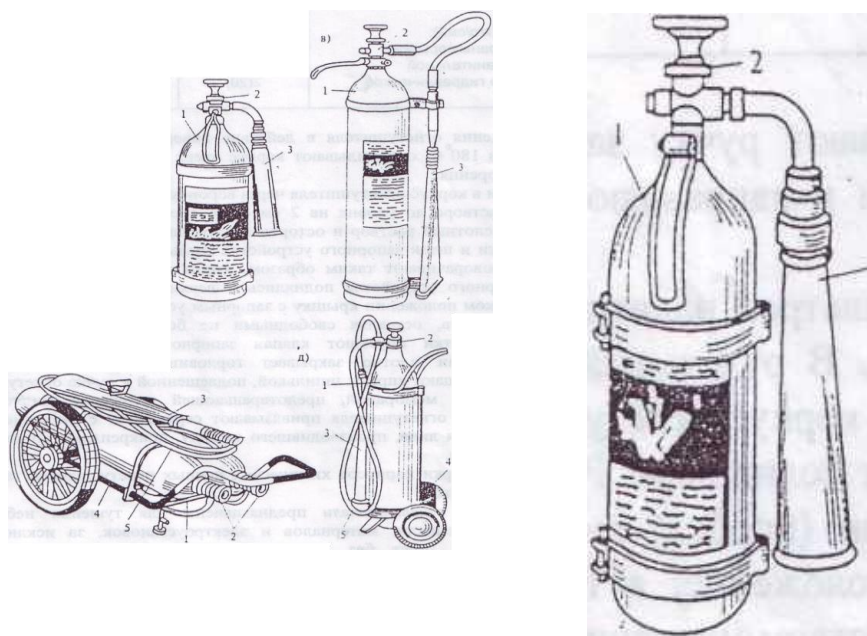
Рис.3 Углекислотные огнетушители: А) ОУ-2; б) ОУ-5; в) ОУ-8; г) УП-2М; д) УП-1М.
