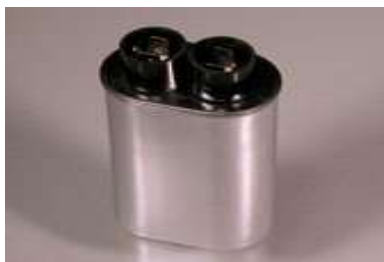
Рис.2 Высоковольтный конденсатор микроволновой печи
