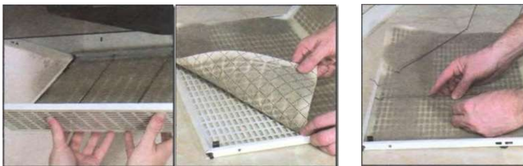
Рис.3 Замена жирославливающего фильтра
