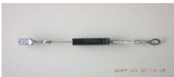
Рис. 3 Высоковольтный диод СВЧ печи
