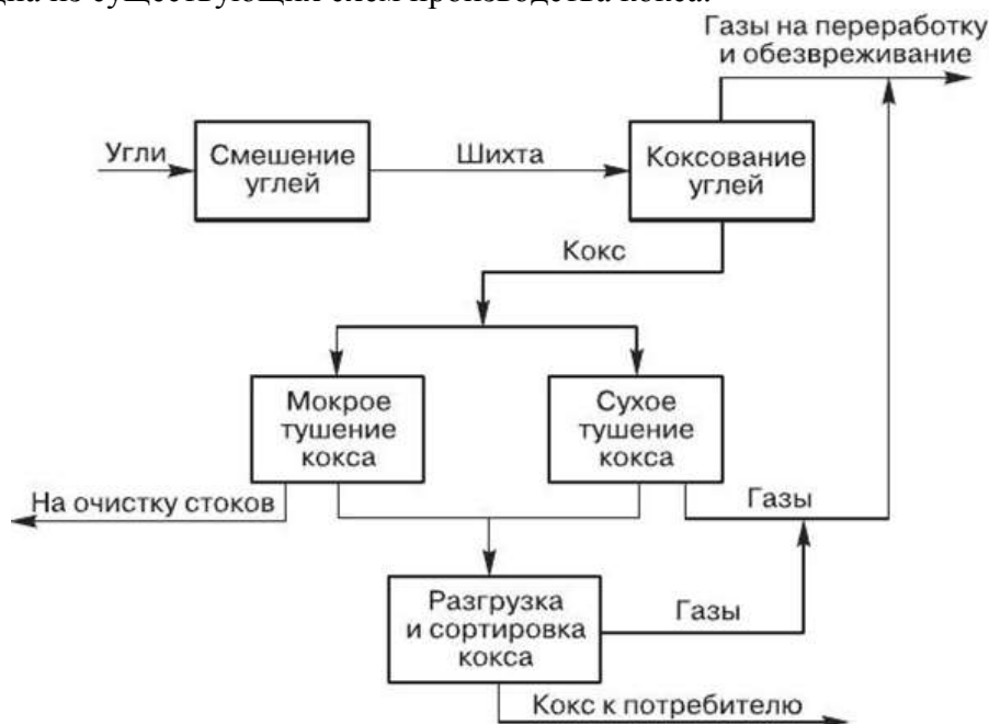
Рис. 1 – Технологическая схема производства кокса
