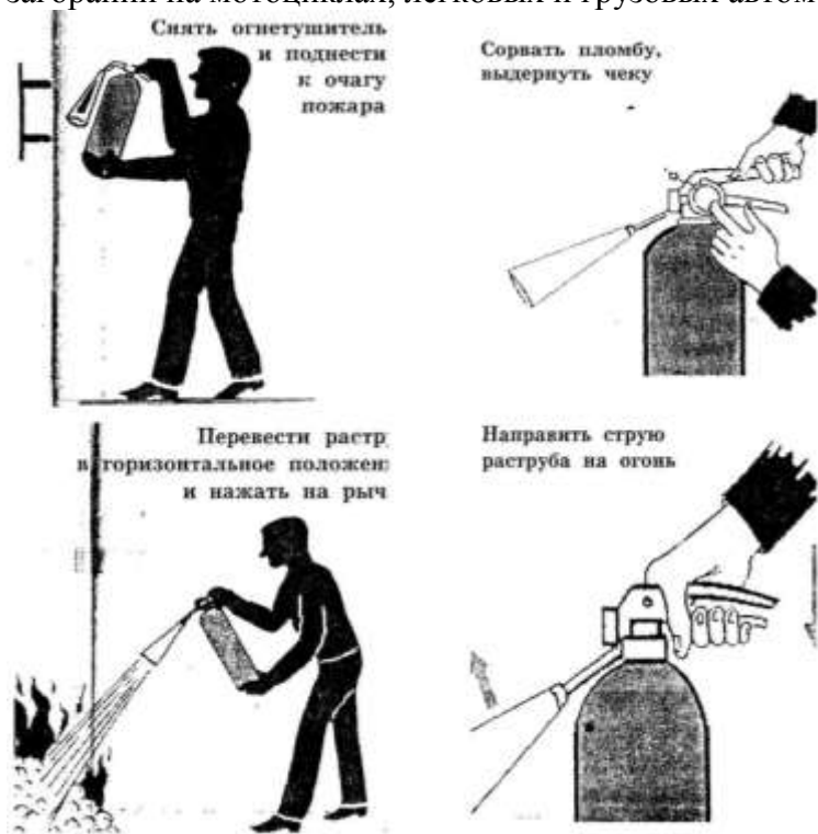
Рис. 3. Приведение в действие ручного углекислого огнетушителя.
