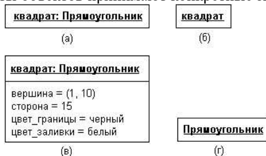
Рис. 11. Пример графического изображения объектов на диаграммах языка UML
