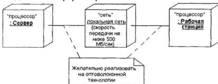
Рис. 3. Фрагмент диаграммы развертывания с соединениями между узлами
