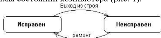
Рис. 1. Простейший пример диаграммы состояний для технического устройства типа компьютер
