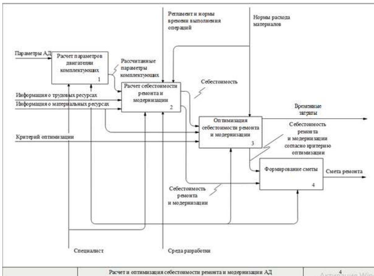
Рисунок 2 - Детализация функциональной схемы программного обеспечения
