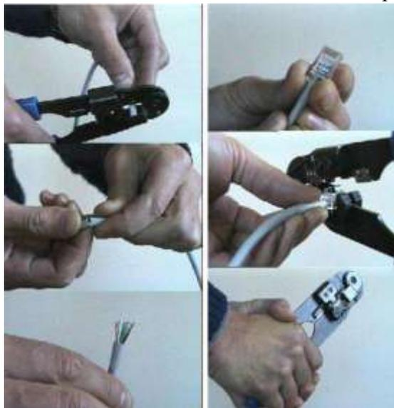
1. Ближе всего к рукояткам устройства располагается область, в которой установлен нож для обрезания проводников витой пары.
