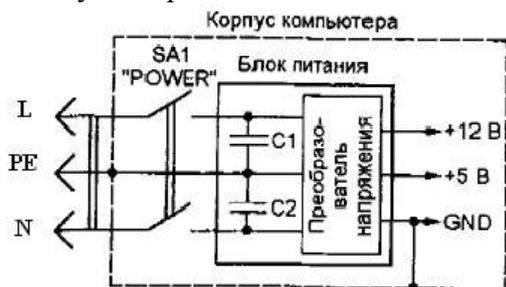
Рис. 2. Типовая схема подключения СВТ к питающей сети.
