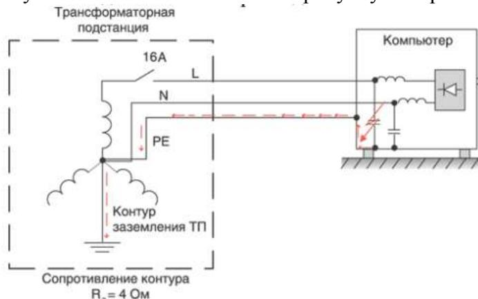
Рис.1. Система заземления СВТ.
