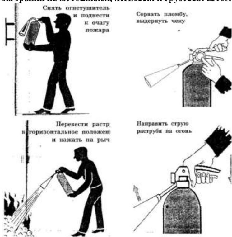
Рис. 3. Приведение в действие ручного углекислого огнетушителя.
