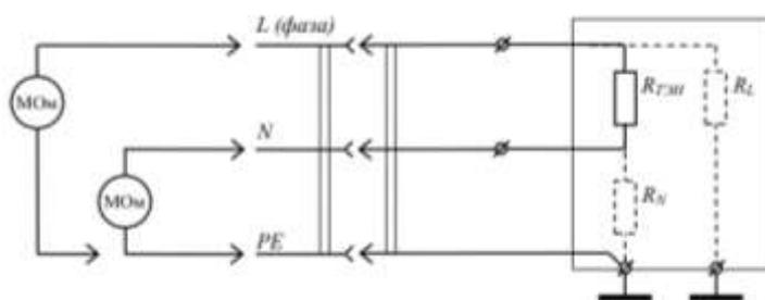
2. Изучите схему измерения сопротивления изоляции ТЭНа.
