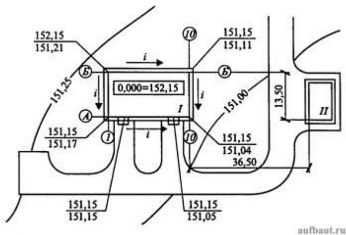
**Рисунок 1. Пример выполнения вертикальной и горизонтальной привязок в учебной практической работе:** *I* - проектируемое здание; *II* - существующее здание; *i* - направление стока поверхностных вод; *A, Б, I, 10* - обозначения осей
