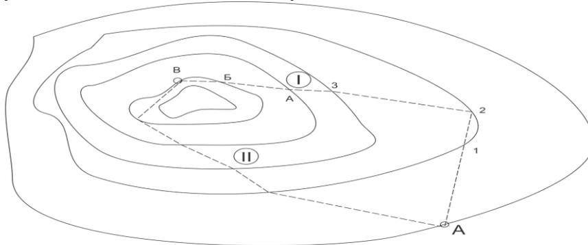
Рис. 16. Схема проектирования трассы с заданным уклоном
