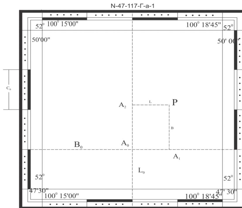
Рис. 10. Определение графических координат точки на карте
