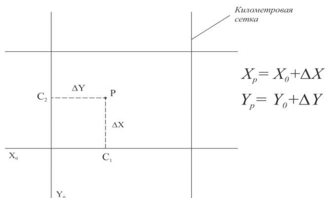
Рис. 11. Определение прямоугольных координат точки на карте
