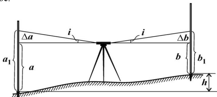
Рисунок 19. Проверка цилиндрического уровня. Измерения из середины
