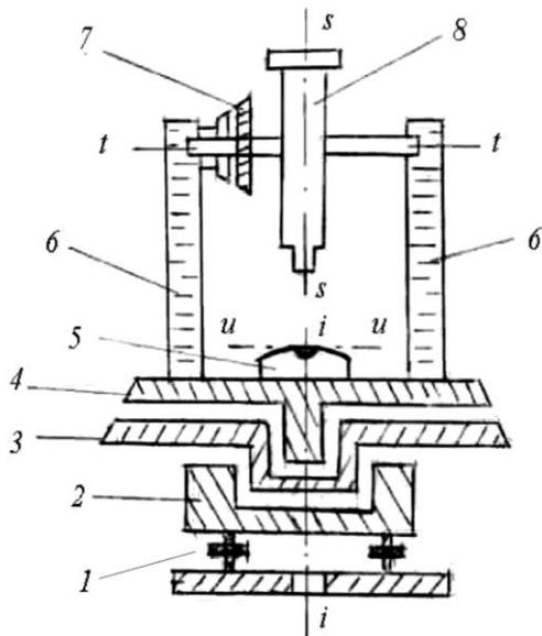
Рисунок 1. Схема устройства теодолита: *ii* – ось вращения алидады; *tt* – ось вращения трубы; *ss* – визирная ось трубы; *uu* – ось уровня алидады.
