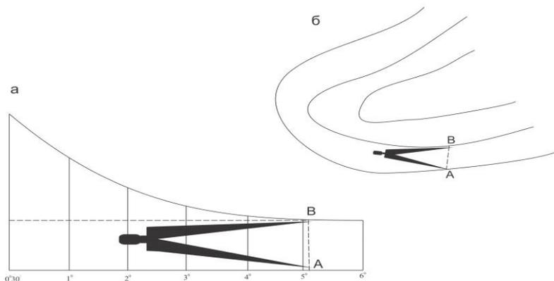
Рис. 15. схема определения крутизны ската по графику заложений
