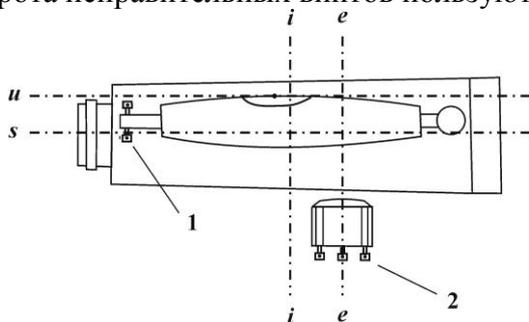
Рисунок 18. Оси и исправительные винты нивелира:  $ss$  – визирная ось зрительной трубы;  $ii$  – ось вращения прибора;  $iii$  – ось цилиндрического уровня;  $ee$  – ось круглого уровня; 1 – исправительные винты цилиндрического уровня; 2 – исправительные винты круглого уровня.
