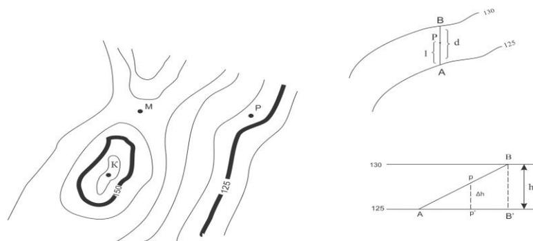
Рис. 14. Схема определения отметок точек по горизонталям
