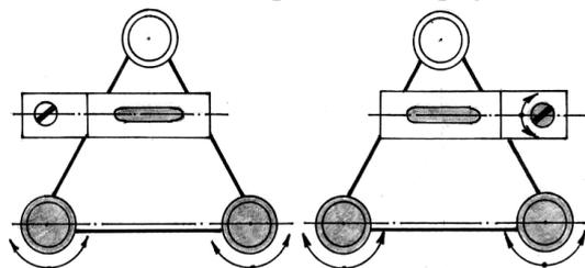
Рисунок 10. Первая поверка теодолита
