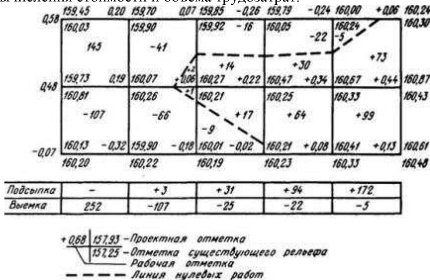
Рисунок 1. Подсчет объема земляных работ
