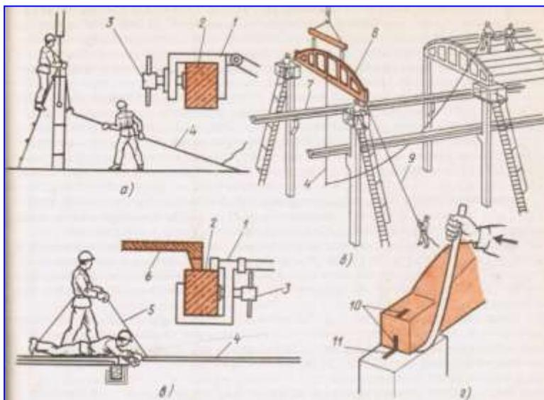
Для установки железобетонной фермы на опорные части колонн наносят риски осей здания, если они не были нанесены при геодезической съемке. Если фермы будут крепиться болтами, проверяют резьбу, навинчивая до конца гайки, после чего их снимают, кладут в ящик для инструмента.
