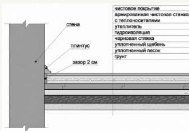
На следующем этапе выполняется визуальное обследование пола, в ходе которого выявляются все дефекты: трещины, сколы, перепады высот, отсутствие элементов напольного покрытия (плитка, паркет, доски, стяжка, наливной пол, топпинг и так далее). При необходимости уточнения "пирога" конструкции выполняется вскрытие пола в контрольных точках. По результатам визуального осмотра составляется отчет, в состав которого включается:
