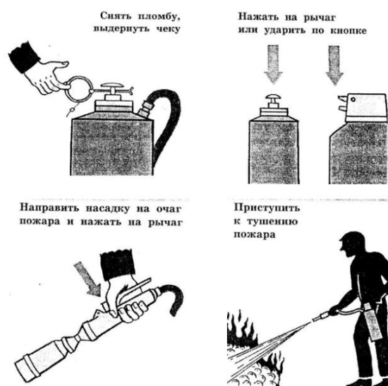
Рис.1. Приведение в действие воздушно-пенного огнетушителя.
