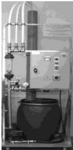
Рисунок 1 - Внешний вид стенда. Центробежный насос; 2-Датчик давления; 3-Задвижка для регулирования дросселированием; 4-Монометр; 5-Монометр после задвижки; 6-Ротаметр; 7-Задвижки для имитации потребителя; 8-Шкаф с системой управления приводом насоса; 9-Сливная труба; 10-Ёмкость с водой.
