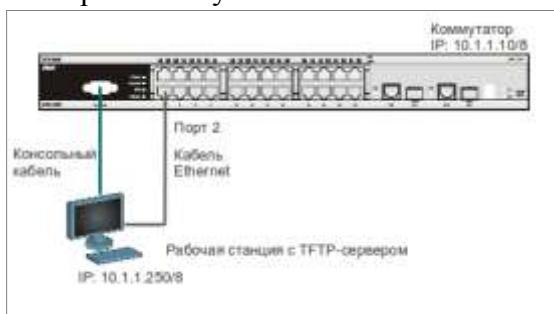
2. Изучить и выполнить команды обновления программного обеспечения коммутатора и сохранения/восстановления конфигурационных файлов.
