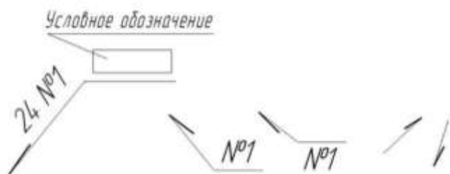
Рисунок 102 – Условные обозначения при наличии на чертеже одинаковых швов:
