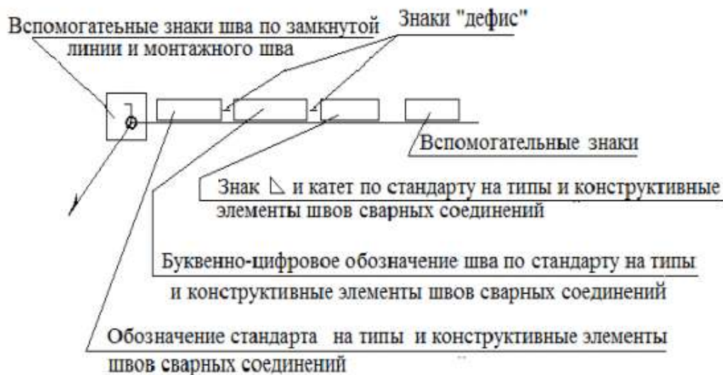
Рис.101 Схема условного обозначения стандартных сварных швов
