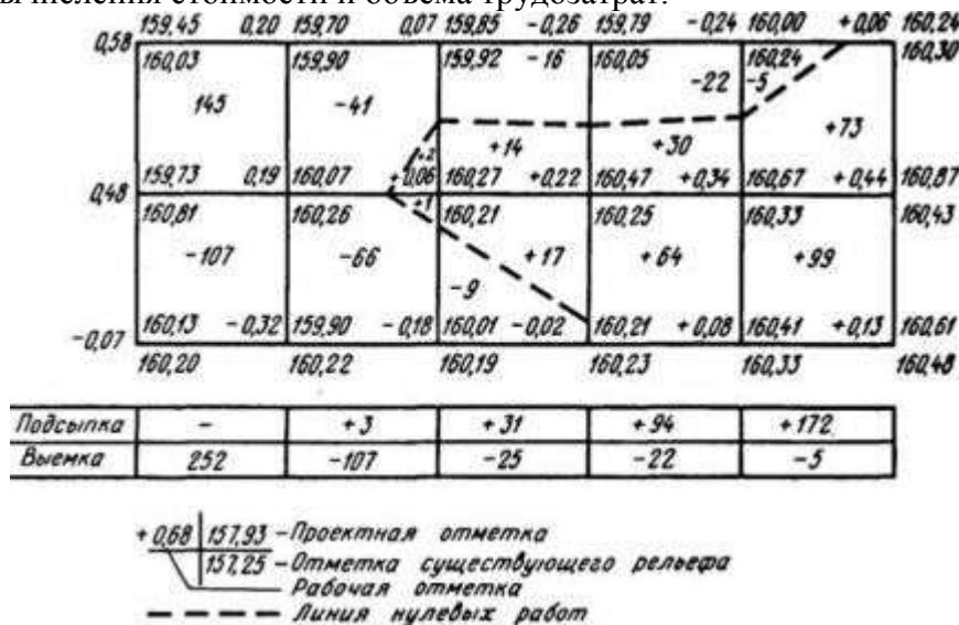
Рисунок 1. Подсчет объема земляных работ
