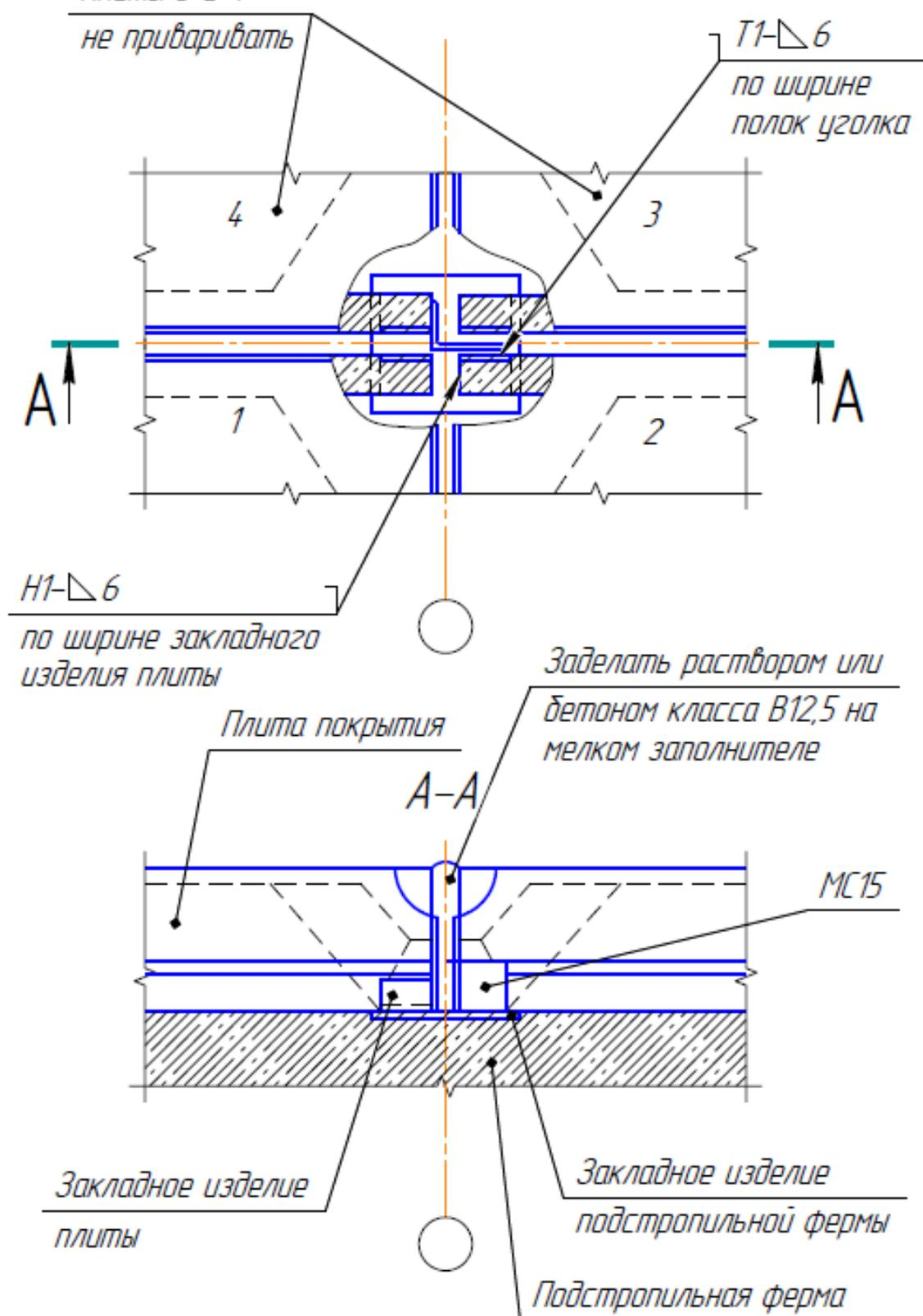
*Крепление плиты покрытия к стропильной конструкции по крайнему ряду колонн в торце секции*
