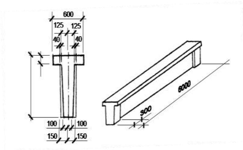
Рис. 4.6. Подкрановая балка для шага колонн 6 м
