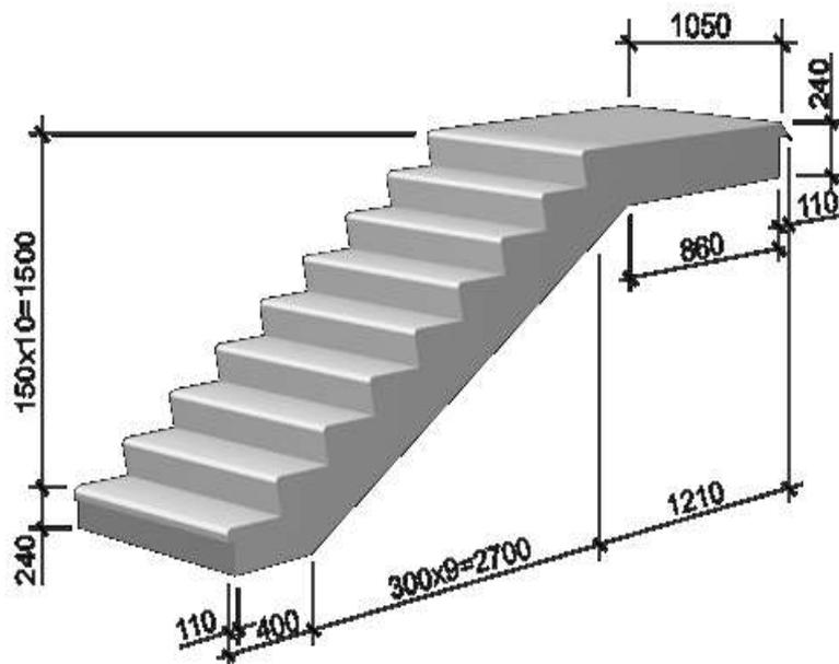
Рис. 9.20. Лестничные марши железобетонные совмещенные с лестничными площадками
