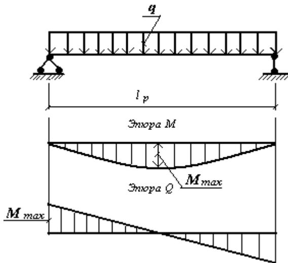
Рисунок 12 – Расчетная схема полки ребристой плиты покрытия
