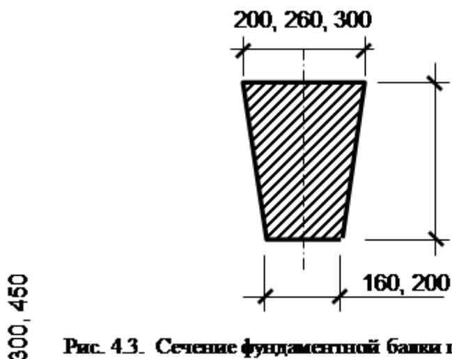
**Рис. 4.3. Сечение фундаментной балки при шаге колонн 6 м**
