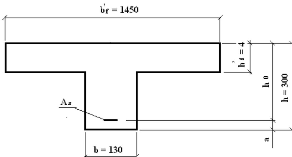
Рисунок 15 – Расчётное сечение продольного ребра
