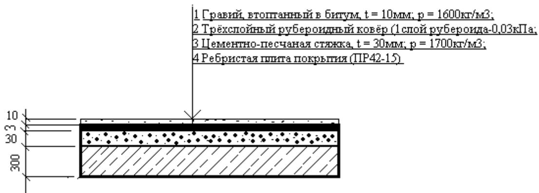
Рисунок 11 – Многослойная конструкция для расчета нагрузки на ребристую плиту перекрытия
