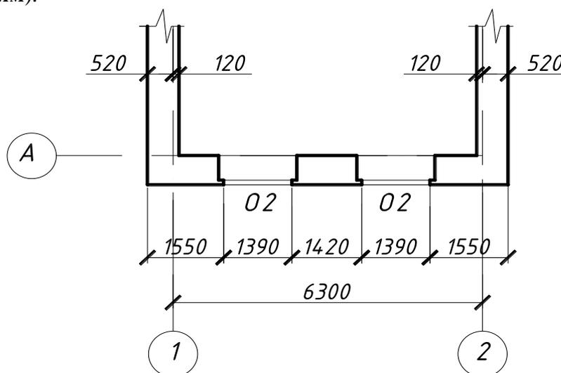
Рисунок 12- Расчет простенков
