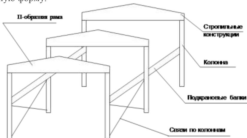
Рис. 3.1. Каркас здания
