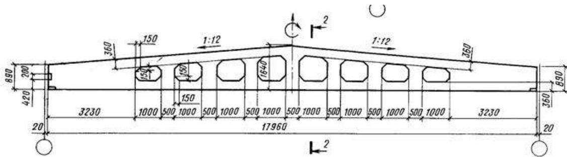
Рис. 4.9. Стропильные балки (пролеты 12 и 18 м)
