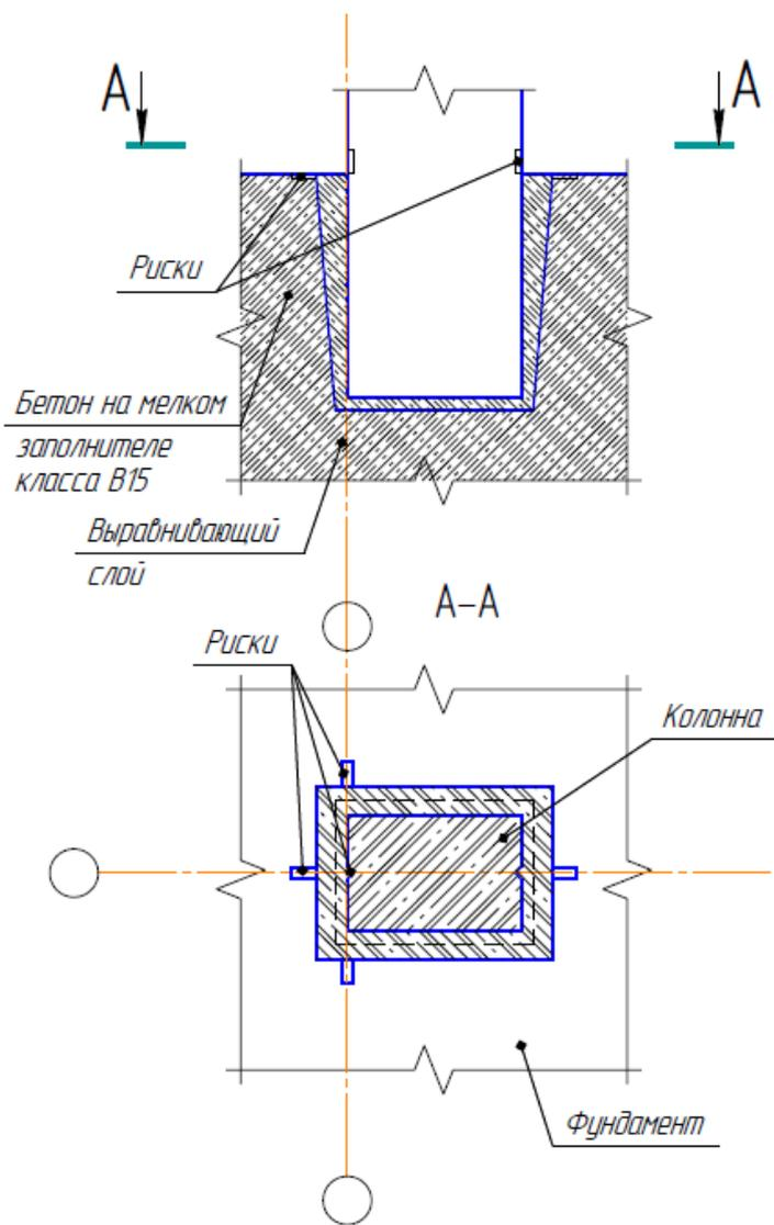
*Заделка в фундамент колонны прямоугольного сечения среднего ряда секции*
