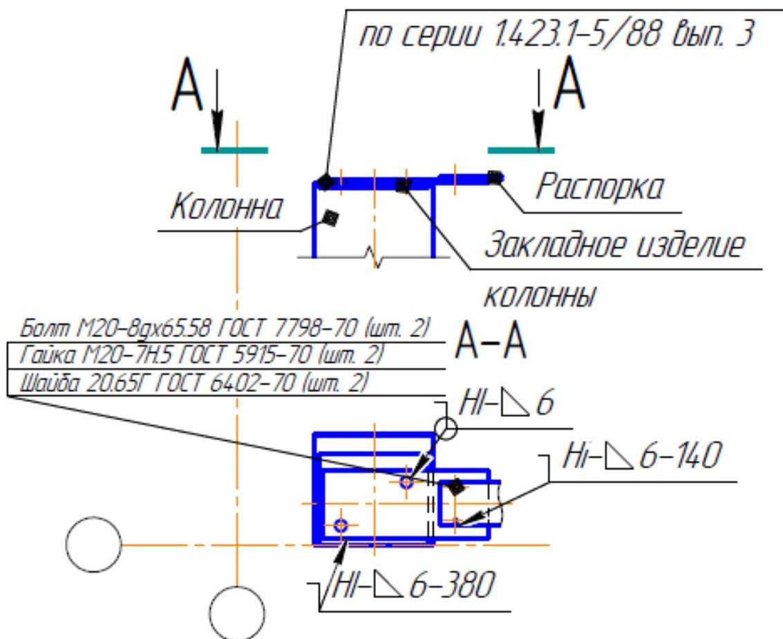
Крепление подкрановой балки пролетом 6 метров к колонне у торца секции
