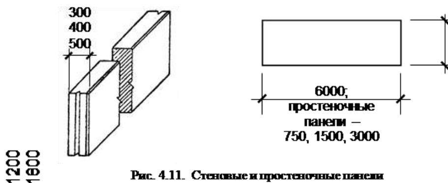
Рис. 4.11. Стеновые и простеночные панели
