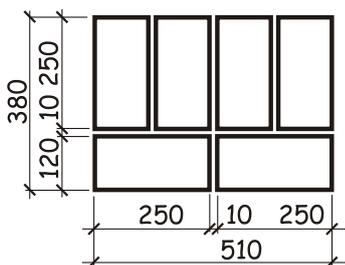
2. Изобразить поперечное сечение столба. Если размеры сечения столба даны в кирпичах, перевести их в мм. Размеры кирпича в плане 250\*120мм. Целый кирпич – это его длина, полкирпича – ширина, шов между кирпичами – 10мм. Определить площадь сечения столба:  $A = b \cdot h$ , м<sup>2</sup>. Если  $A > 0,3\text{ м}^2$ , то коэффициент условия работы  $\gamma_c = 1$ . Если  $A \leq 0,3\text{ м}^2$ , то  $\gamma_c = 0,8$  - п.3.11<sup>а</sup> [3].
