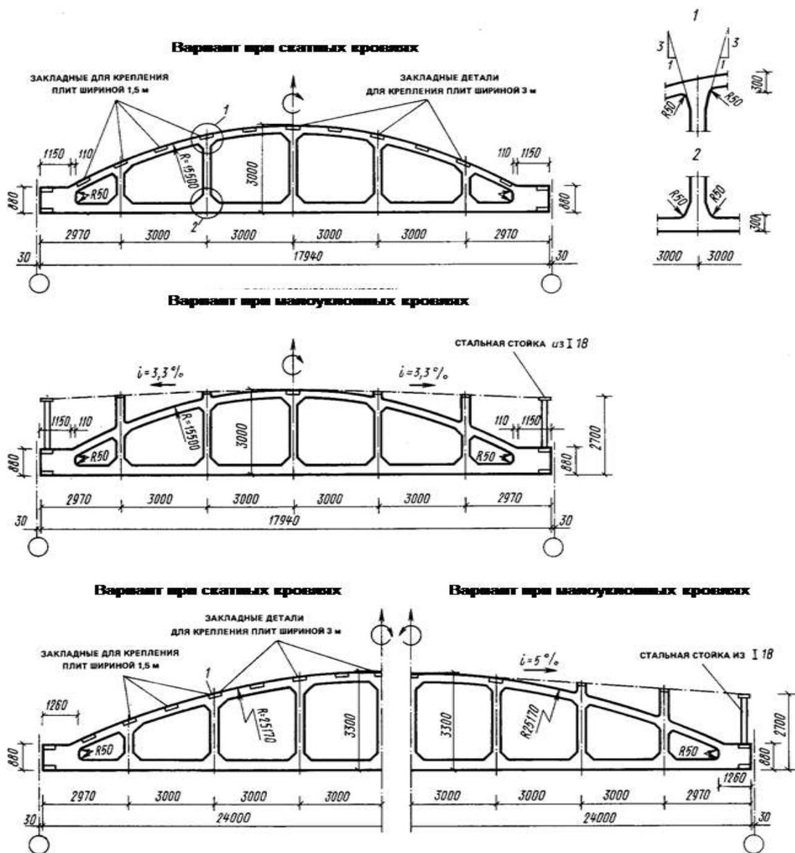
**Рис. 4.8. Стропильные фермы (пролеты 18 и 24 м)**
