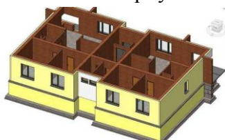
Рис. 7. Модель со скрытым внешним слоем кирпичной кладки
