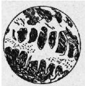
Рис. 7 Структура доэвтекктического чугуна
