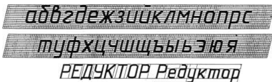
Рис.17 Буквы чертежного шрифта
