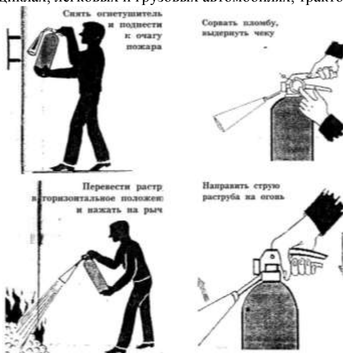
Рис. 3. Приведение в действие ручного углекислого огнетушителя.
