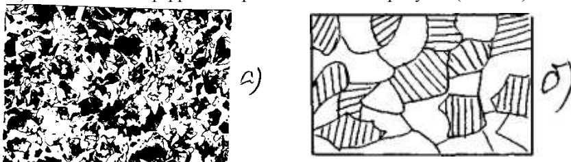
Рис. 4.2. Микроструктура (а) и ее схема (б) стали 30ХГСА после отжига
