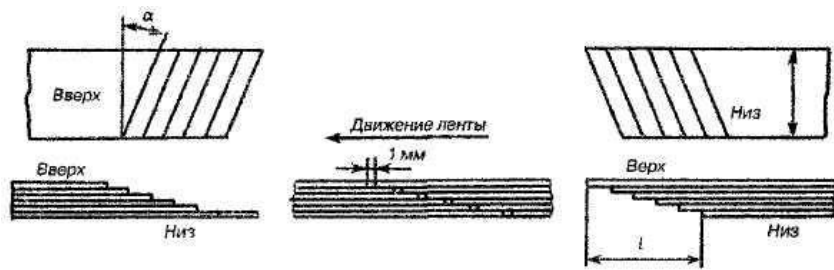
Рисунок 2.6 – Схема подготовки ленты к вулканизации
