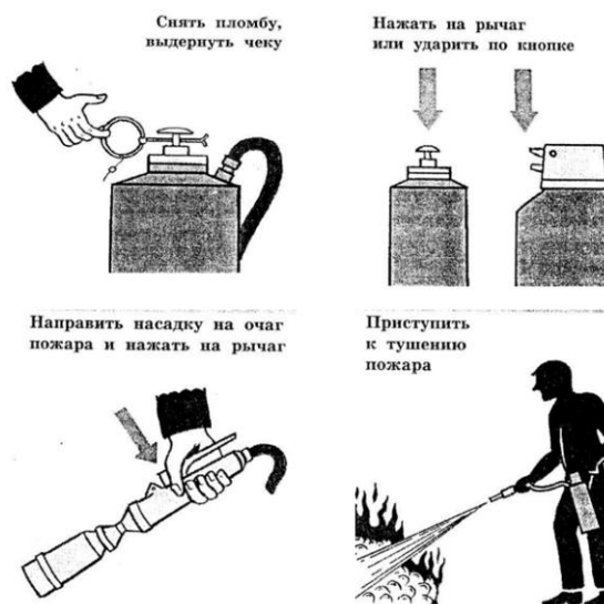
Рис.1. Приведение в действие воздушно-пенного огнетушителя.
