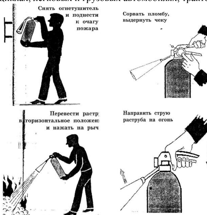
Рис. 3. Приведение в действие ручного углекислого огнетушителя.
