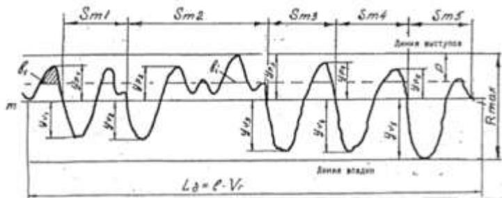
Для обработки профилограммы задаются значения базовой длины  $l = 2,5$  мм и уровня сечения профиля  $p = 25\%$ . Параметры шероховатости, полученные по профилограмме, сравнить с заданными
