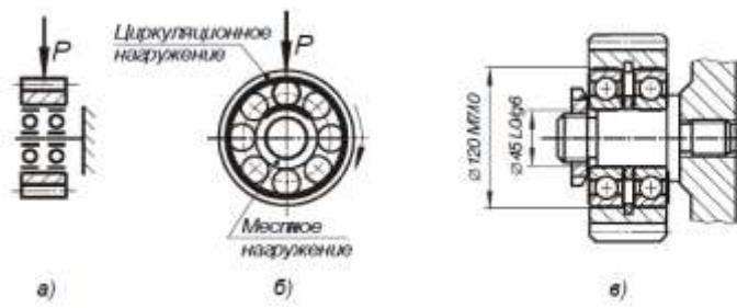
**Третья типовая схема.** Внутренние кольца подшипников вращаются вместе с валом, наружные кольца, установленные в корпусе, – неподвижны. На кольца действуют две радиальные нагрузки, одна постоянна по величине и по направлению  $P$ , другая, центробежная, вращающаяся вместе с валом.
