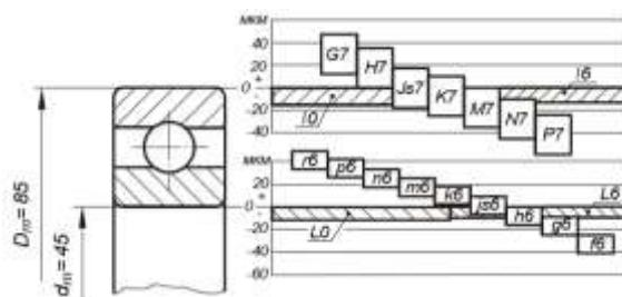
Из схемы видно, что поля допусков для внутреннего и наружного колец подшипника качения расположены одинаково относительно нулевой линии, верхнее отклонение равно 0, нижнее – отрицательное.
