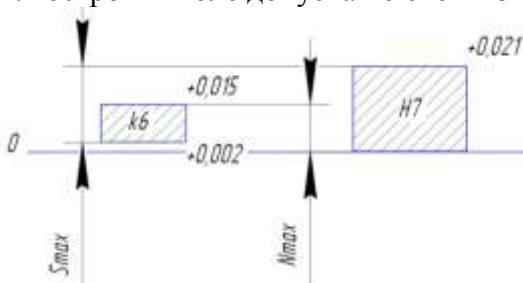
т.к. на поле допуска вал перекрывается отверстием полностью, посадка называется **переходной**.
