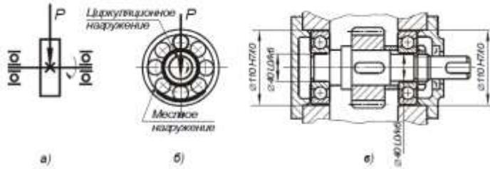
**Вторая типовая схема.** Наружные кольца подшипников вращаются вместе с зубчатым колесом. Внутренние кольца подшипников, посаженные на ось, остаются неподвижными относительно корпуса. Радиальная нагрузка  $P$  постоянна по величине и не меняет своего положения относительно корпуса.
