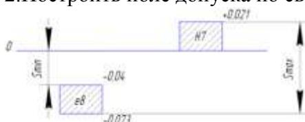
т.к. размеры вала меньше размеров отверстия посадка называется **с зазором**.
