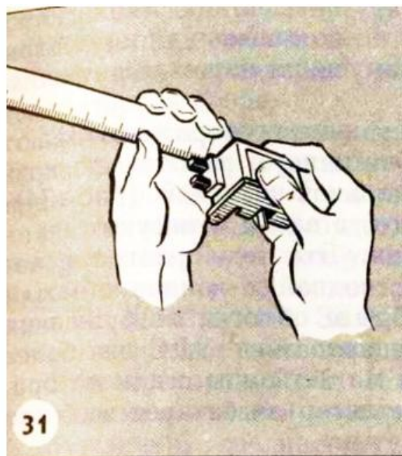
Рисунок 7. Измерение высоты щетки
