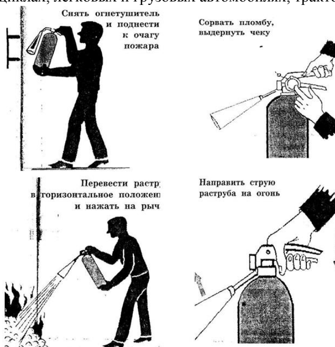
Рис. 3. Приведение в действие ручного углекислого огнетушителя.
